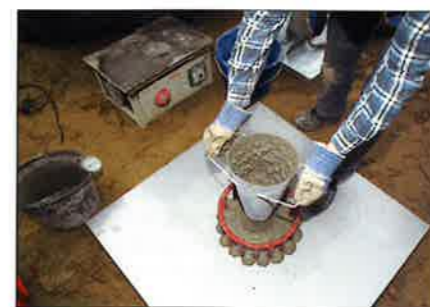
Prüfung des Setzfließmaßes eines selbstverdichtenden Betons mit Blockierung auf der Baustelle.
